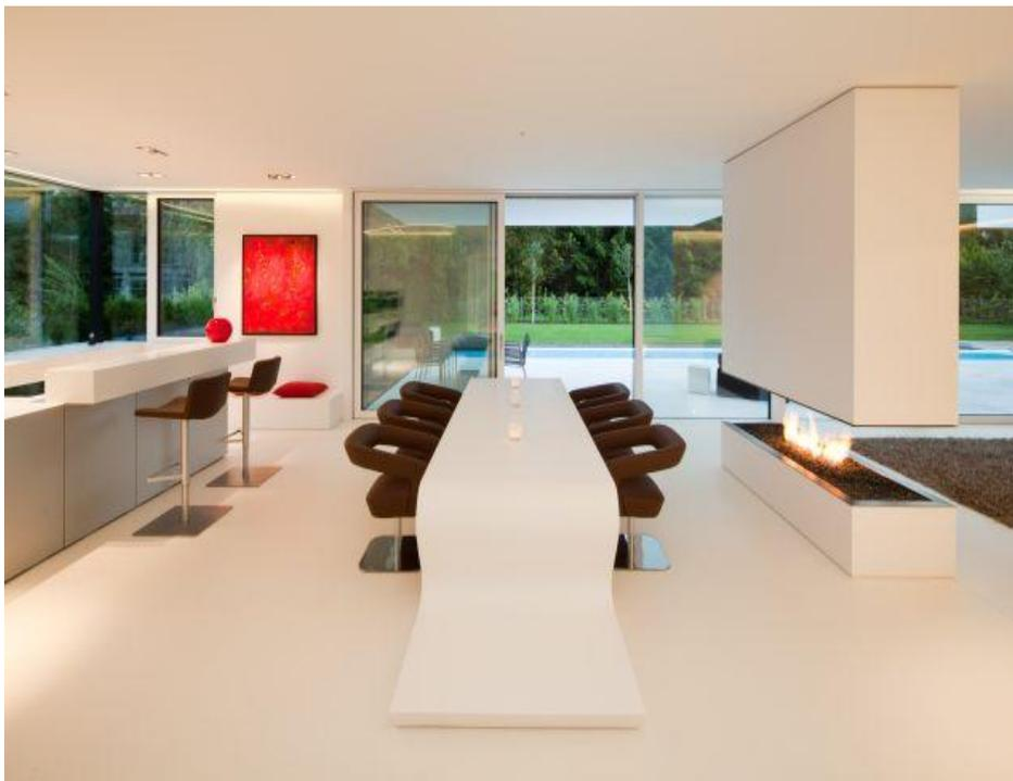
3 Metallvierkantrohre dienen als zusätzliche Verstärkung. Dank dieser Eigenkreation steht der Tisch selbst über diese enorme Länge perfekt in der Waage. Die einzelnen Teilelemente wurden auf das Metallgerüst aufgebracht, zusammengefügt, verklebt und am Ende wurde der gesamte Tisch
